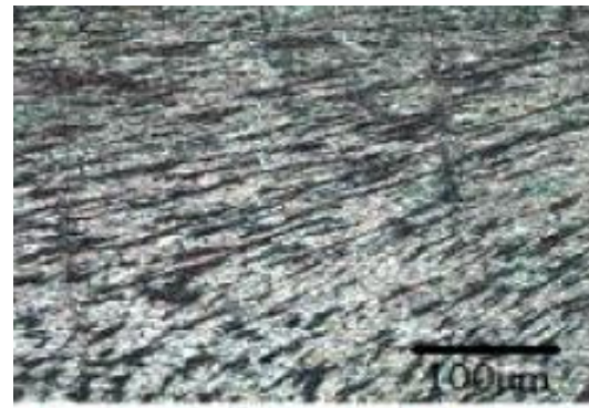
(d) Microstructure (1.5gm of mg, 40 mm/min Feed, 1000)
